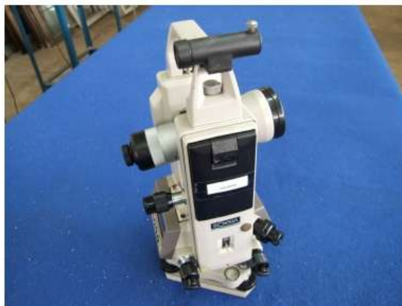
รูปภาพที่ ๒๐ แสดงกล้องวัดมุมระบบอิเล็กทรอนิกส์ ที่มา: นายชาติชาย ฉัตรทอง.(๒๕๖๓). การสำรวจด้วยกล้องวัดมุม.
